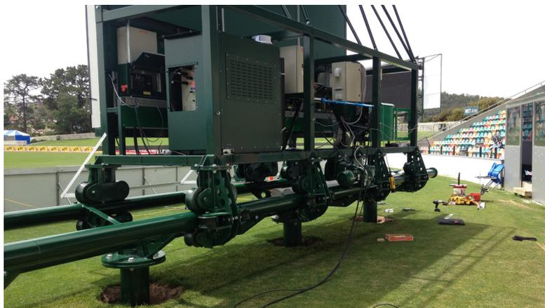
所需的减速机输出力矩取决于两部分:一部分是屏幕的重量和小车的重量，另一部分是本地区的强风所引起的帆效应。从这些具体条件可以计算出所需的最小力矩为  $M_2 = 1,000 \text{ Nm}$ 。由减速机输出轴的力矩值和速度值可以推算出所需要的功率约为 5 kW。
