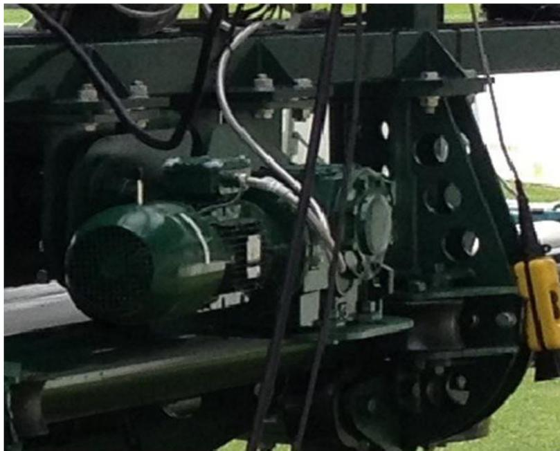
完整的技术方案还包括一台 7.5 kW 的变频器，远程控制设备(非 Motovario 供货)通过它来控制这两台减速机。该远程控制设备可以在远处控制屏幕的移动。
